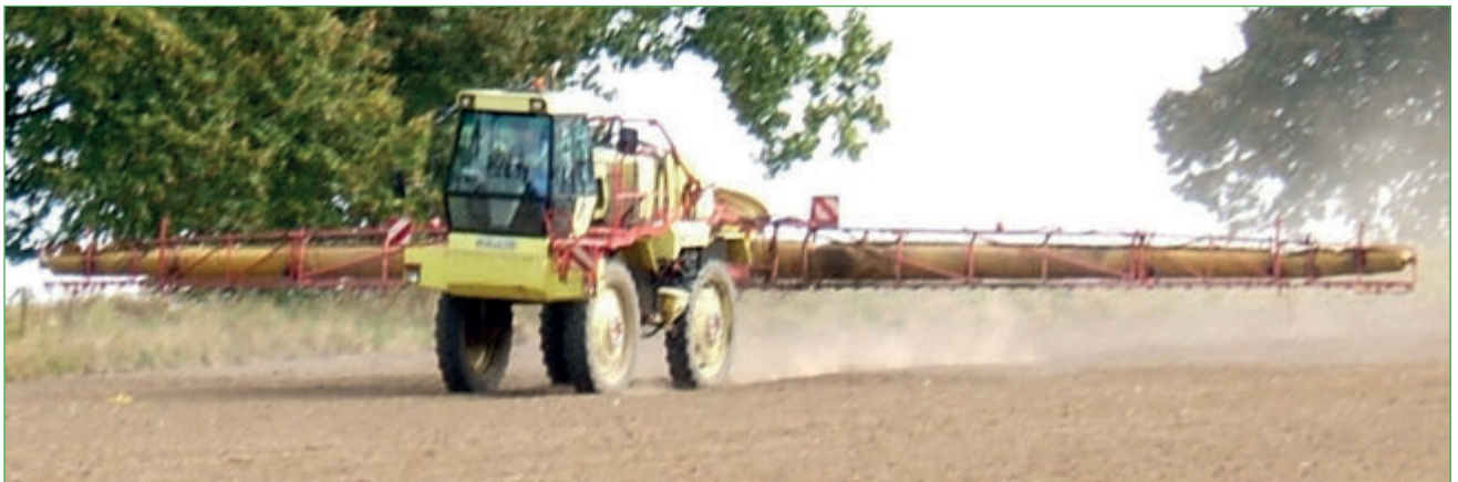
Abdrift durch falsche Spritzbalkenhöhe
