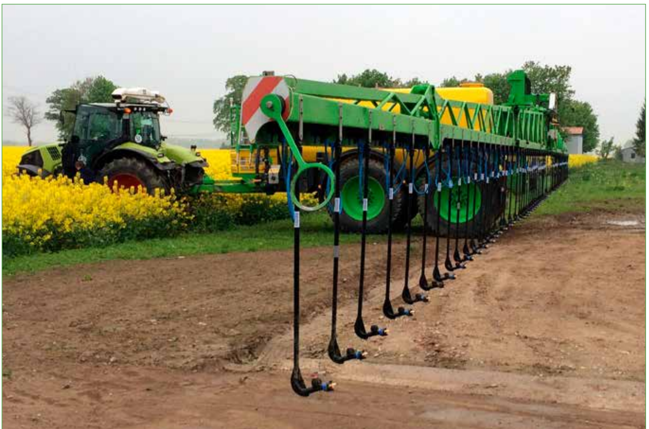
Dropleg-Technik – startklar für den Einsatz (Lechler)
